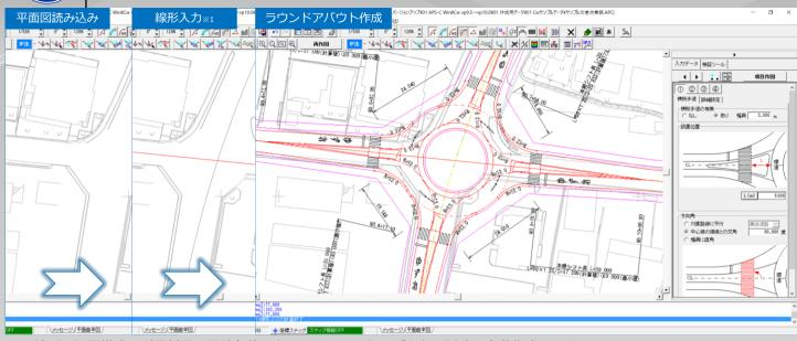
線形・幅員構成など最低限の設計条件入力によりラウンドアバウトを瞬時に自動作成します。 また、信号交差点と同様に線形や設計条件の変更に合わせてリアルタイムに形状が更新されます。
