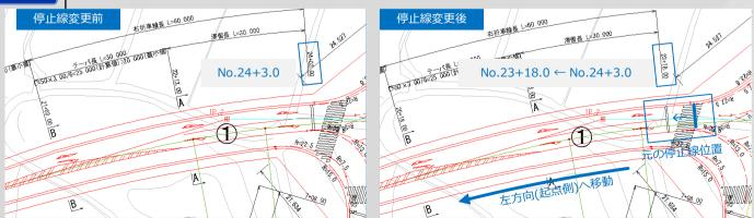
停止線位置はマウス操作、測点入力、路肩線からの距離入力などの設定方法で検討できます。 また、停止線位置の変更と同時に「横断歩道」「路面標示」等が自動で更新されます。 曲線区間においても自動更新されますので、設定ミスを防止できます。
