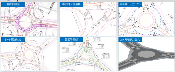
交差点形状の検討に必要な「軌跡図」「導流路・交通島」「自転車ナビライン」等をチェック1つで作成します。 さらに縦断線形・横断勾配を設定し、ラウンドアバウトの路面等高線を計算し、計算結果からボタン1つで3次元モデルを作 成できます。
