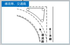
左折導流路から導流帯、交通島を作成 できます。また、内側・ノーズオフセッ トのゼブラもボタン一つで瞬時に作図し ます。
