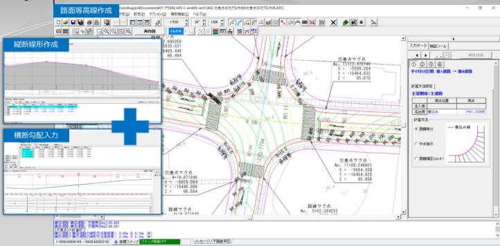
作成した交差点に対して、交差道路の主従関係、縦断線形、横断勾配を設定しますと路面等高線を自動作成します。 また、交差点及び道路のサグ点を自動計算し旗上げしますので、交差点部の集水桝位置検討や施工計画(舗装仕上げ高)の資 料作成にご利用頂けます。
