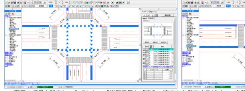
専用の幅員を設定し、作成したい「道路番号」「流入・流出」を指定するだけで、自転車専用レーンを自動作成します。 また、ナビライン(矢羽)の「種類」「サイズ」は設定により変更できます。
