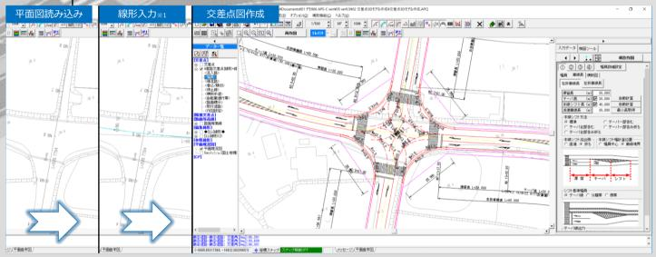
線形・幅員構成など最低限の設計条件入力により交差点図を瞬時に自動作成します。
